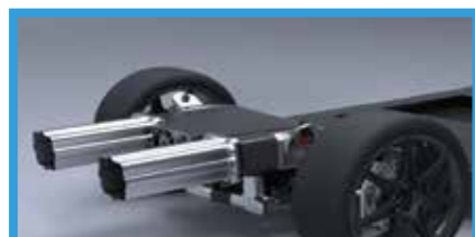
纵梁 Longitudinal Beam
